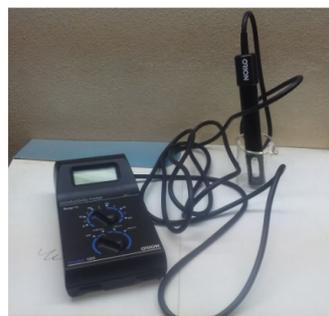
**Figura 10b.** Conductímetro.
