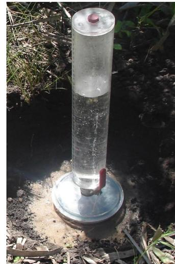
**Figura 9.** Infiltrómetro o permeámetro de disco.
