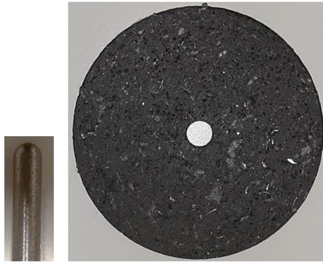
Fig. 1: Imágenes del pin cilindro de cara semiesférica y del disco
