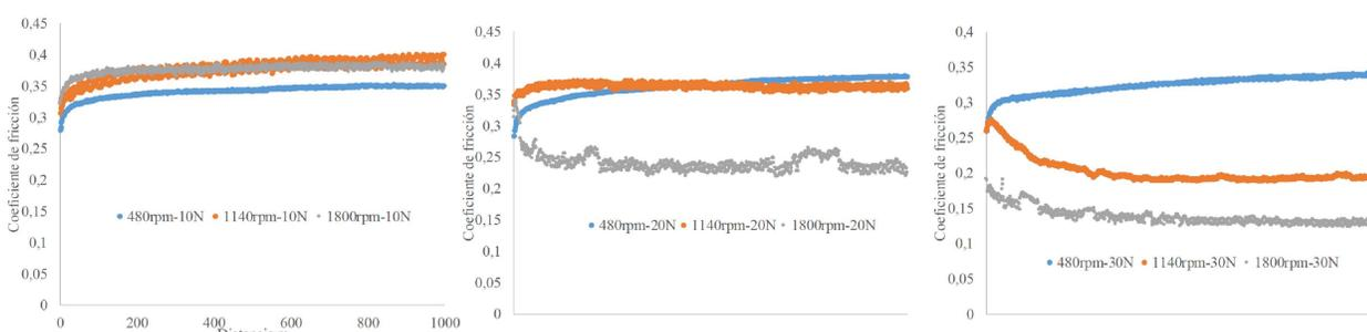
Fig. 2: Valores de fricción en función de la carga y velocidad
