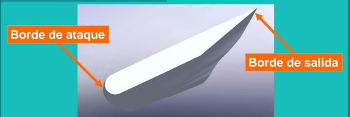
Según normas N.A.C.A: PERFIL BICONVEXO SIMÉTRICO
