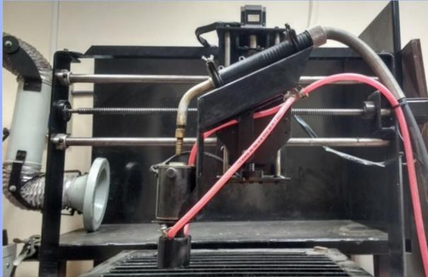
Figura n°1: Banco de soldadura robotizado.
