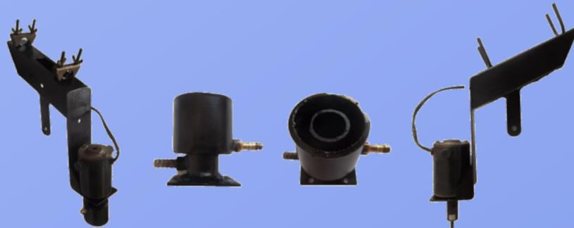
Figura n°2: Sistema de arco rotante con doble tobera.
