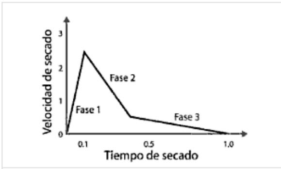
Figura 31: diagrama del tiempo vs velocidad del secado según (Oregon A., 2008)
