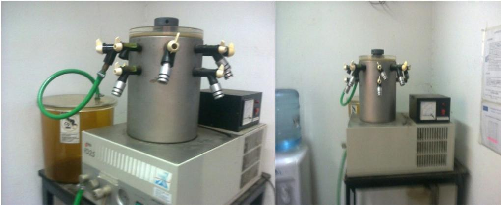
Figura 11: Liofilizador utilizado para el proceso
