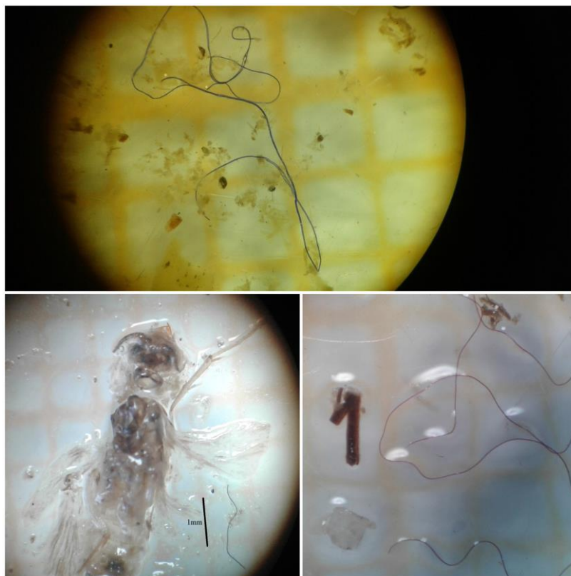
Figura 15. Filamentos de micro y meso plástico observados bajo lupa binocular (20 X y 40 X aumentos), escala de representación 1 mm. Fuente: Acosta et al. (2019)
