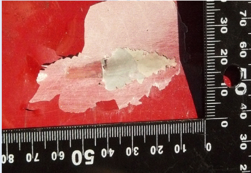
Impacto con punta "Full Jacket", punta ojival calibre 9 mm con un ángulo de incidencia de 0°
