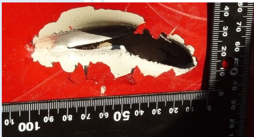
Impacto con punta "Full Jacket", punta ojival calibre 9 mm con un ángulo de incidencia de 20°
