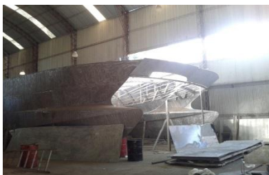
Figura 4. Chapas de aluminio para la formación de la carcasa
