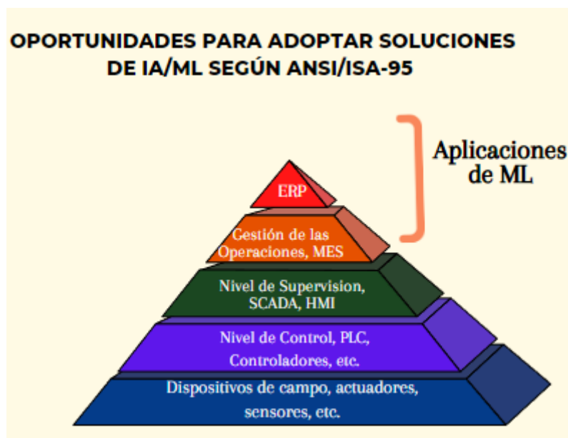
Fig. 3. Donde se presentan las oportunidades de adopción de soluciones de ML en los procesos industriales según el estándar ISA 95.
