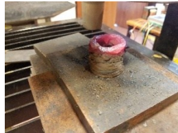
Proceso de fabricación de un cilindro elaborado con consumible que deposita martensita con carburos de Cr, Mo y V. Foto: Gentileza Dr. Ing. A. Gualco - Laboratorio de Soldadura FiUNLZ.-
