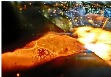
Nueva técnica de análisis por imágenes en tiempo real de soldadura. Imagen obtenida de la pileta líquida y metal base en el Laboratorio de Soldadura FIUNLZ. Foto: Gentileza Dr.Ing. A. Guaco
