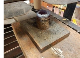
Proceso de fabricación de un cilindro elaborado con consumible que deposita martensita con carburos de Cr, Mo y V. Foto: Gentileza Dr. Ing. A. Gualco - Laboratorio de Soldadura FiUNLZ.-
