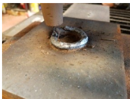
Proceso de fabricación de un cilindro elaborado con consumible que deposita martensita con carburos de Cr, Mo y V. Foto: Gentileza Dr. Ing. A. Gualco - Laboratorio de Soldadura FiUNLZ.-
