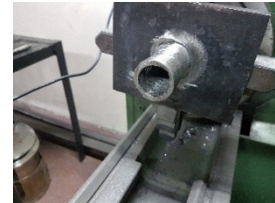
Proceso de fabricación de un cilindro elaborado con consumible que deposita martensita con carburos de Cr, Mo y V. Foto: Gentileza Dr. Ing. A. Gualco - Laboratorio de Soldadura FiUNLZ.-
