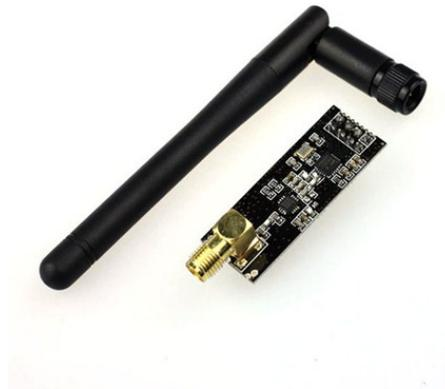
Utilizando este módulo con amplificación de potencia, el alcance puede ser de hasta 1000 mts. en condiciones de campo abierto, pero se logran alcances de 200 o 300 metros en condiciones de ciudad con una relativa visibilidad entre circuitos. Otra opción del módulo es la que viene con antena incorporada:
