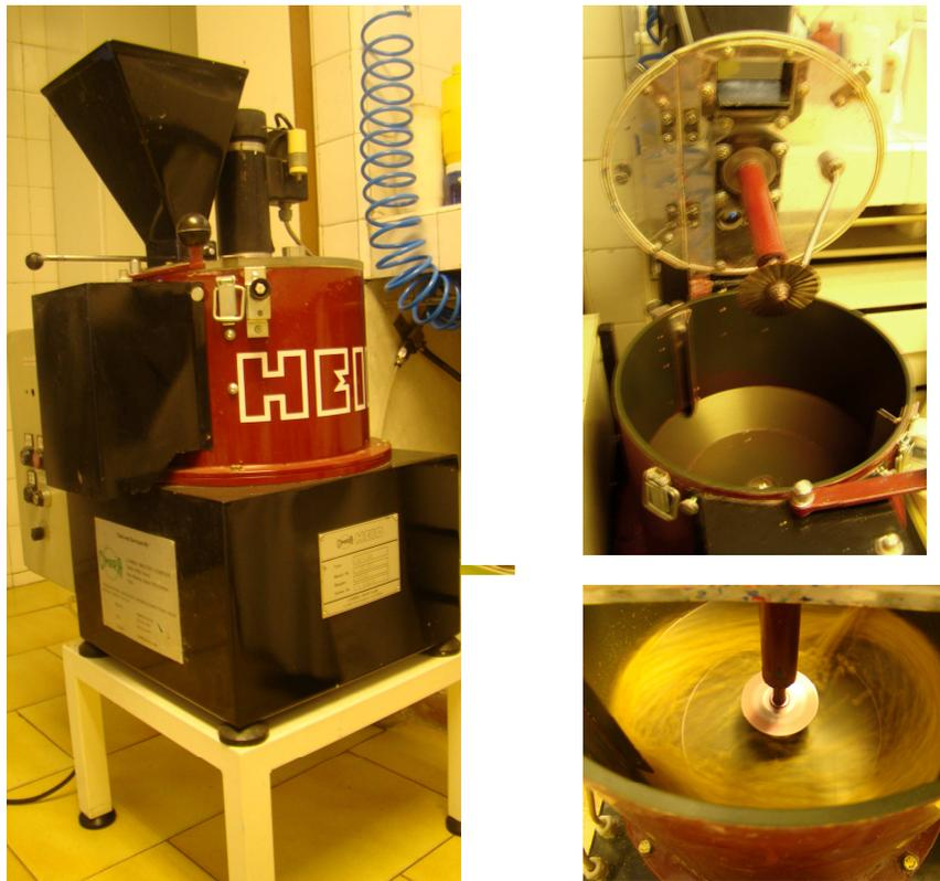
Figura 2.1. Vista de la máquina experimental de incrustado, tipo Cimbría Heyd.
