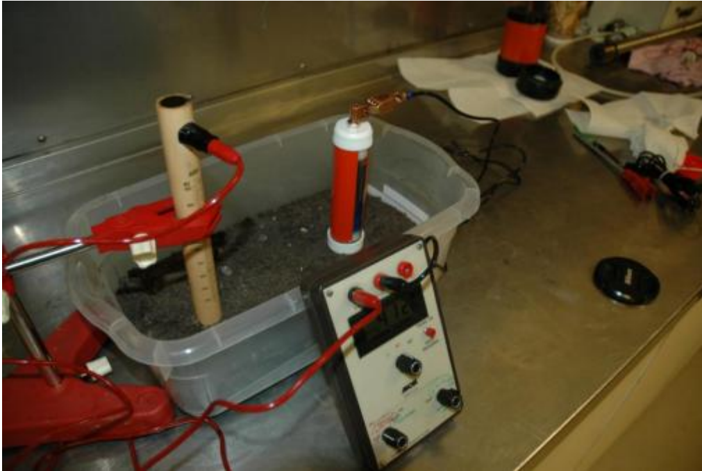
Ilustración 17 - Simulación de medición de pH en batea - Fuente: Manual de instrucciones operativas MCMiller Co.
