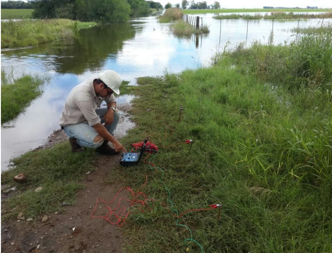
Ilustración 27 - Medición de resistividad zona anegada
