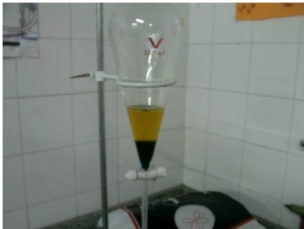
Figura 10: Ampolla de decantación con las fases Ditizona en \text{CCl}_4 y solución de \text{Pb}^{+2}
