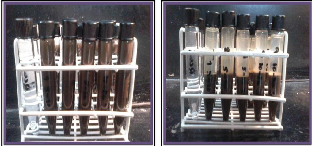
**Figura 3:** Muestras previas a ser incubadas (izquierda) y muestras con siete días de incubación anaeróbica (derecha).
