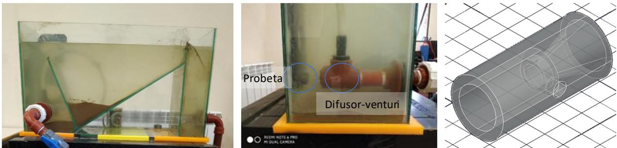
**Figura 1: Maquina de desgaste erosivo.**
