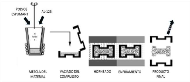
**Fig. 12 – Fabricación de espumas de aluminio por método Foamcarp**
