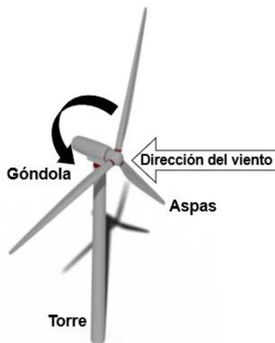
**Fig. 3 – Funcionamiento de un generador de eje horizontal.**
