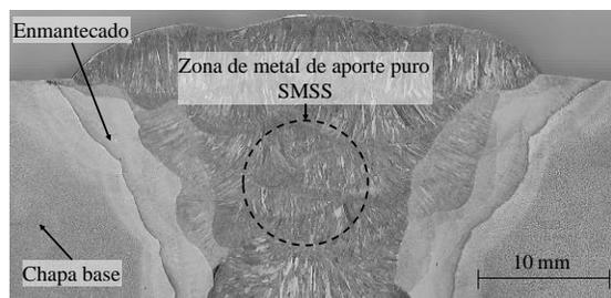
Fig. 1 Macrografía; Depósito de soldadura de SMSS
