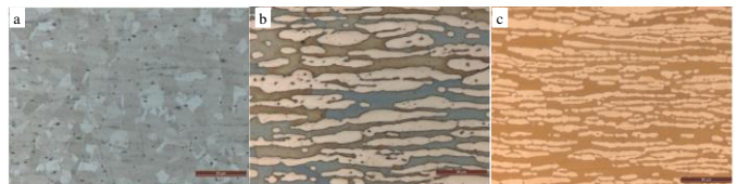
Fig. 2 Microestructura de los materiales base: a) ASS, b) LDSS y c) DSS
