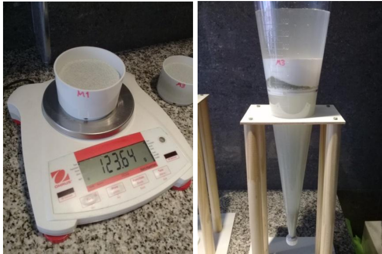
Cámara de reacción M1 durante el pesado inicial y cámara de reacción 3 colocada en el cono de sedimentación tipo Imhoff para la hora 1. Laboratorio LMFA
