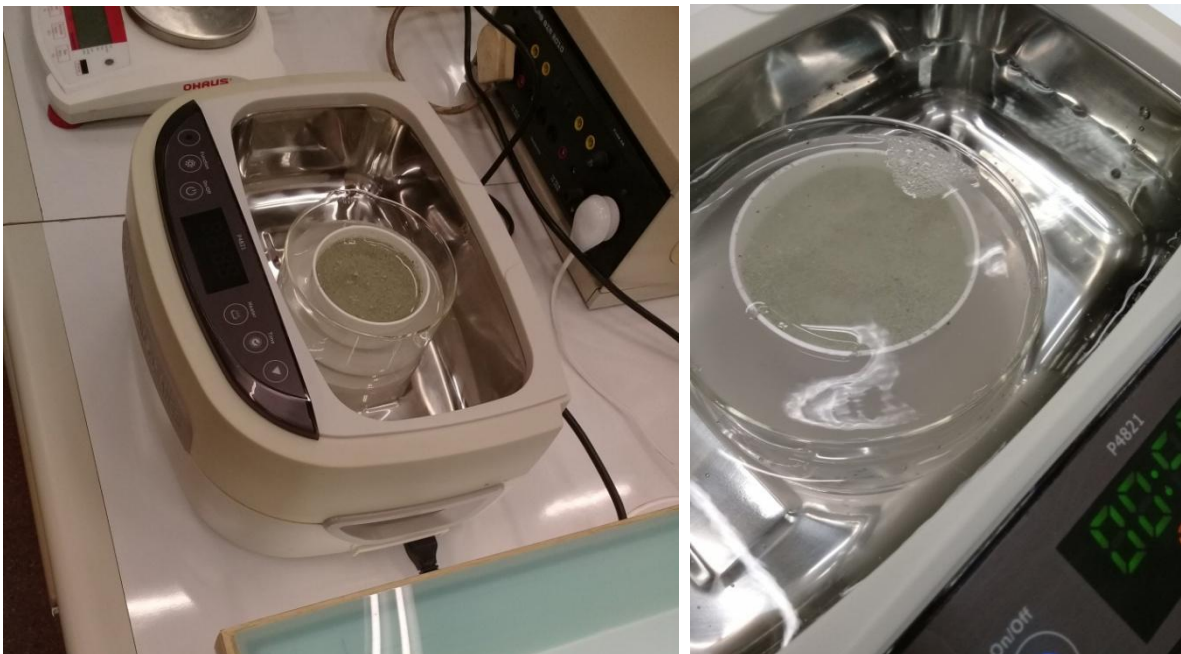
Secuencias del procedimiento aplicado: colocación de la cámara de reacción inmersa en la solución de activación dentro del reactor ultrasónico e irradiación con 28 MHz a 21°C durante 5 minutos. Laboratorio LMFA
