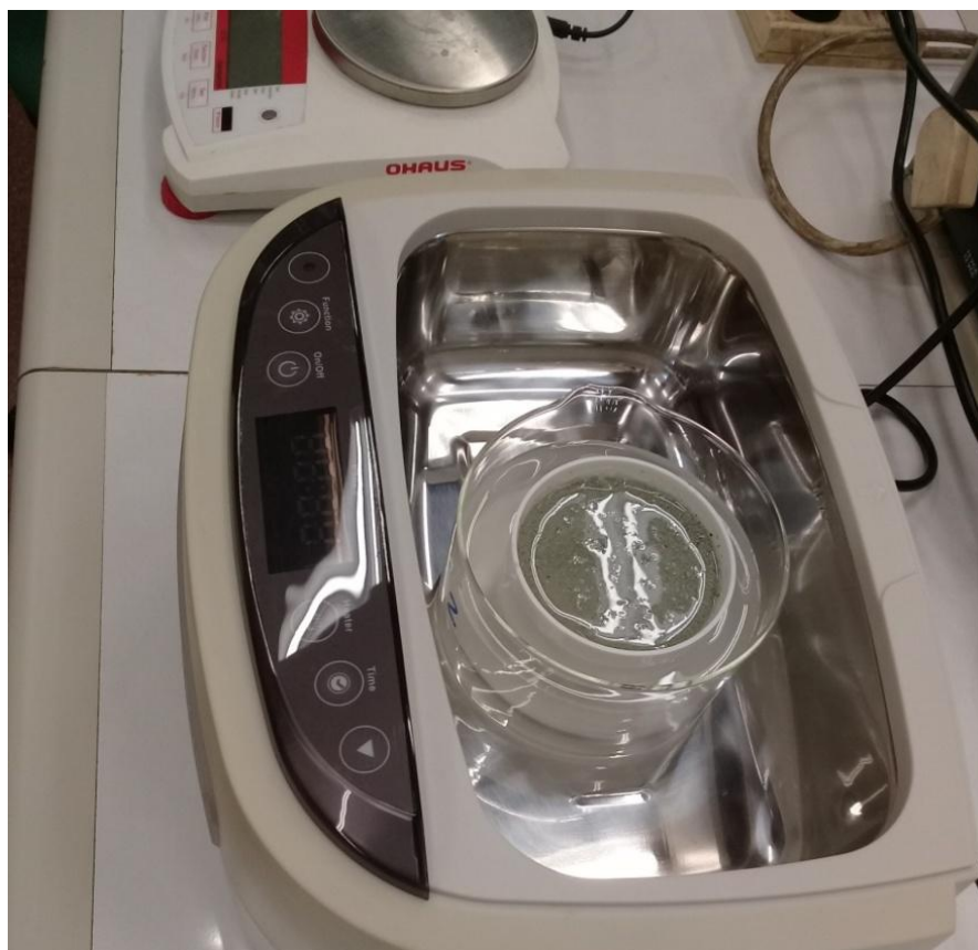
Cámara de reacción con el material a funcionalizar en el interior del reactor ultrasónico, con cristal intermedio de atenuación (28MHz). Laboratorio LMFA
