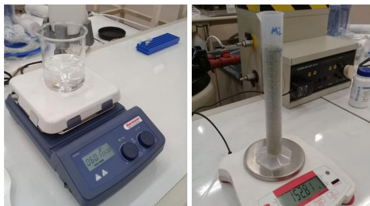
Secuencias del procedimiento aplicado: preparación del agua de desafío con una concentración de 0,25 mg/l de Arsénico y armado de la columna de reacción con el material funcionalizado en etapas anteriores (Muestra M2) Laboratorio LMFA
