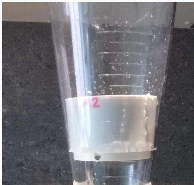
Cámara de reacción con material base colocada dentro del cono tipo Imhoff para la limpieza inicial. Laboratorio LMFA
