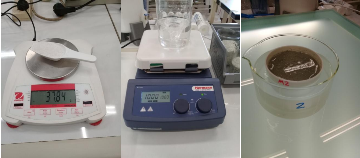
Secuencias del procedimiento aplicado: pesaje, preparación y dosificación de la solución de activación. Laboratorio LMFA
