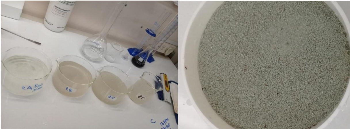
Muestras de aguas residuales obtenidas luego de la irradiación ultrasónica y los 3 enjuagues con agua destilada sobre la Muestra M2, y Muestra M2 en la cámara de reacción luego de finalizado el proceso de enjuague. Laboratorio LMFA
