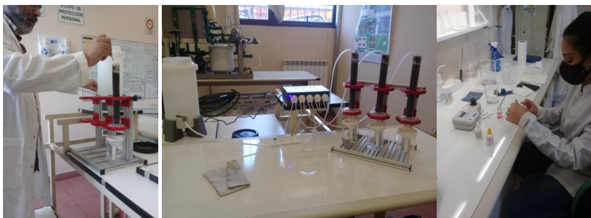
Procedimiento de calibración de las columnas de reacción equivalentes 1:1 mediante carbón activado granular impregnado con sales de plata. Laboratorio LMFA
