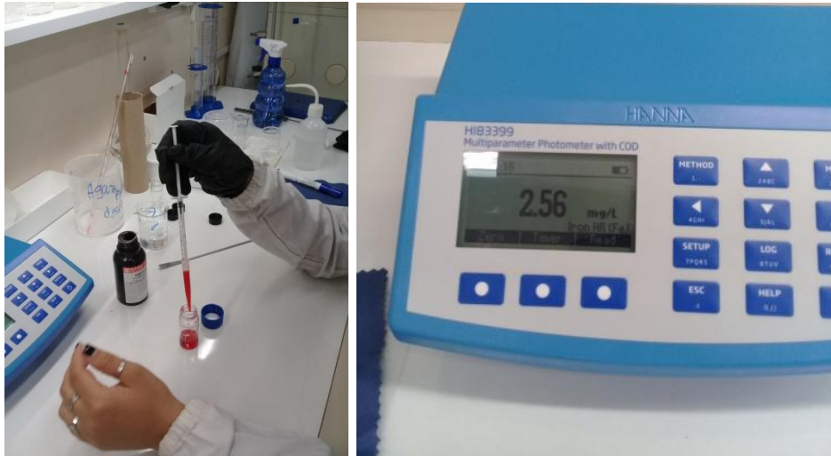
Fotometría láser multiparamétrica para la determinación de Fe+2 en las muestras de aguas residuales obtenidas luego de la irradiación ultrasónica a los 5, 10 y 15 minutos. Laboratorio LMFA
