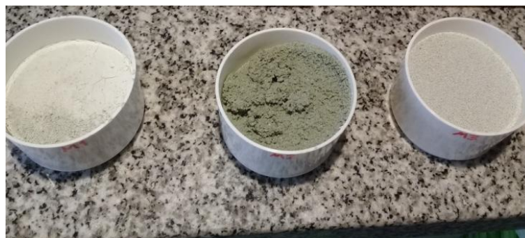
Cámaras de reacción con las Muestras M1, M2 y M3. La Muestra M2 con lavado inicial, Muestras M1 y M3 sin lavado inicial. Laboratorio LMFA
