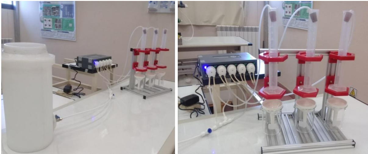
Sistemas porta-columnas completos y detalle de columnas de reacción equivalentes 1:1 diseñados y construidos durante la presente investigación. Laboratorio LMFA
