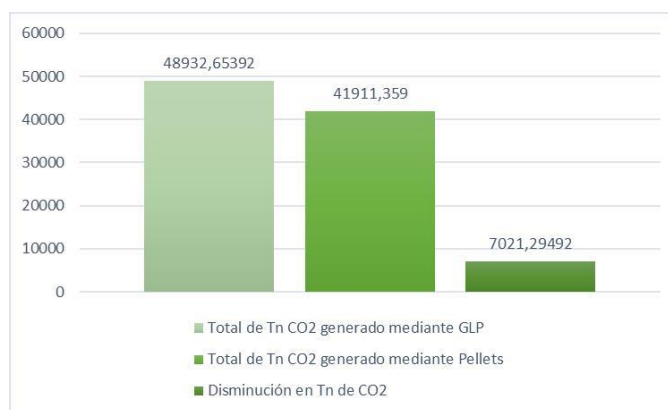
Fig. 2: Comparación del CO 2 generado mediante GLP y su equivalente en pellets. Elaboración propia
