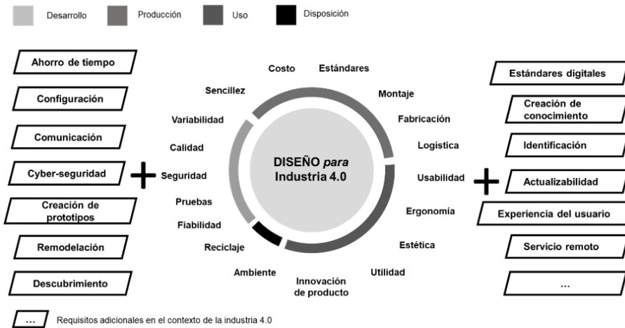
Figura 48 - Diseño para enfoques X en el contexto de la I4.0. (Schuh et al., 2016)
