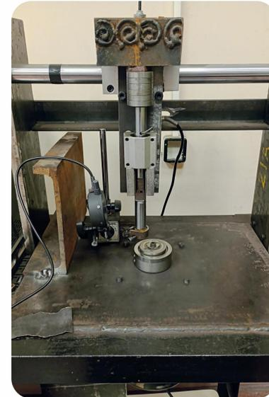
Figura 3: Máquina de ensayo de desgaste.
