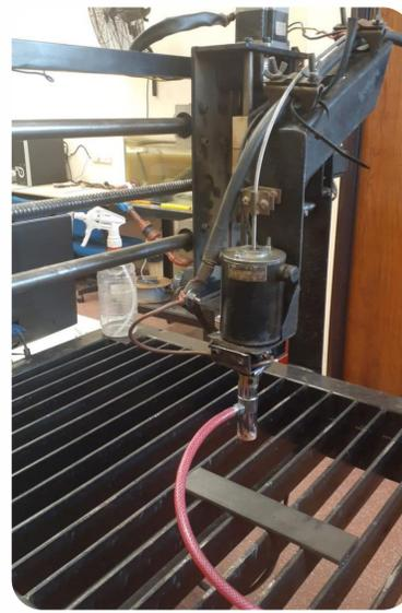
Figura 2: CNC de soldadura de arco rotante
