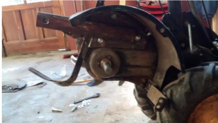
Figura 8. Enganche para traccionar el implemento de labranza con el tractor A (pieza derecha)
