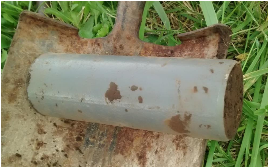
Figura 24. Cilindro para extracción de muestras de suelo para obtener la densidad aparente.
