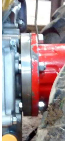
Figura 13. Ensamble Motor-Embrague-Transmisión tractor B.
