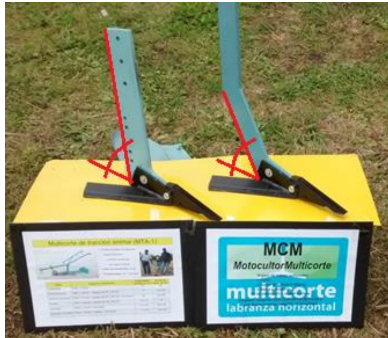
Figura 15. Rediseño y fabricación de la herramienta de labranza y accesorios.(Izquierda: modelo MTA, Derecha: MCM)
