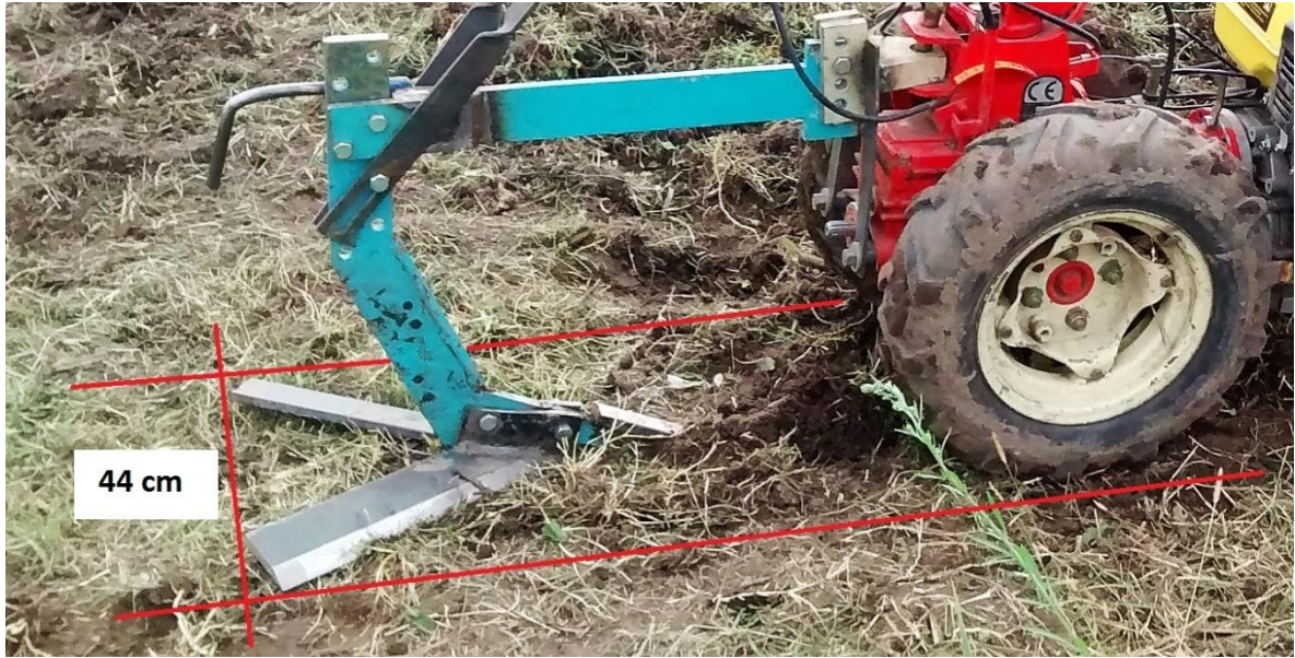
Figura 17. Ancho de trabajo con saetas medianas
