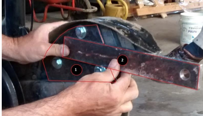
Figura 7. Enganche para traccionar el implemento de labranza con el tractor A (pieza izquierda).
