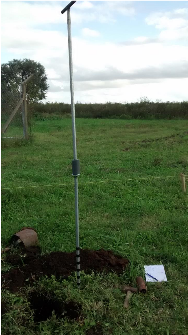
Figura 25. Penetrómetro cónico por golpes
