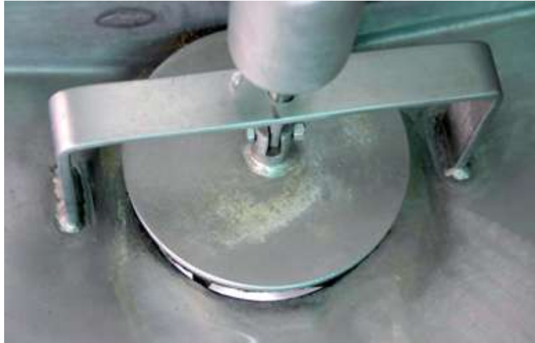
Restos visibles de biofilms microbianos en el desagüe de un tanque de recepción de Leche cruda en una quesería.
