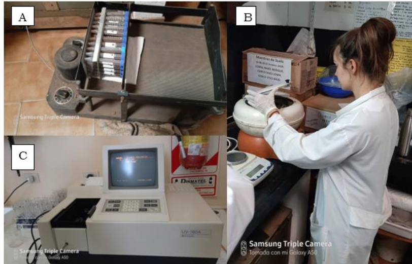
Figura 12: (A) Agitador vaivén, (B) centrifuga y (C) Espectrofotómetro.
