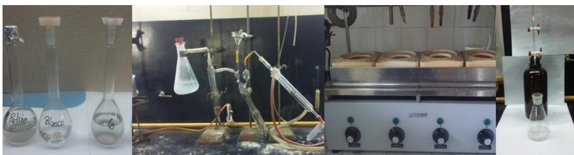
Figura 11: Determinación de Nitrógeno Total por Kjeldahl.
