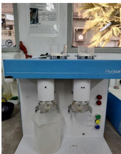
Figura 11. A. Glutomatic. B. Pesaje de muestras en recipientes. C. Lavado de las masas.
