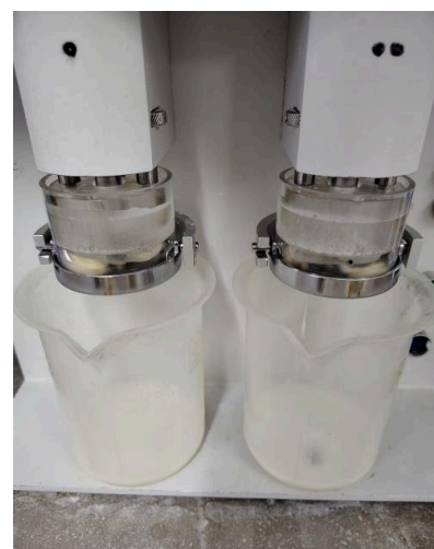
Figura 11. A. Glutomatic. B. Pesaje de muestras en recipientes. C. Lavado de las masas.
