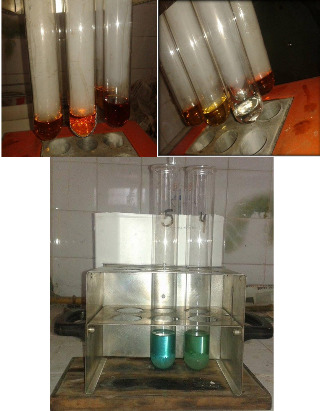
Imagen 14: Método de Kjeldhal: Proceso de digestión.
