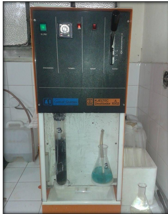
Imagen 15: Método de Kjeldhal: Proceso de destilación
