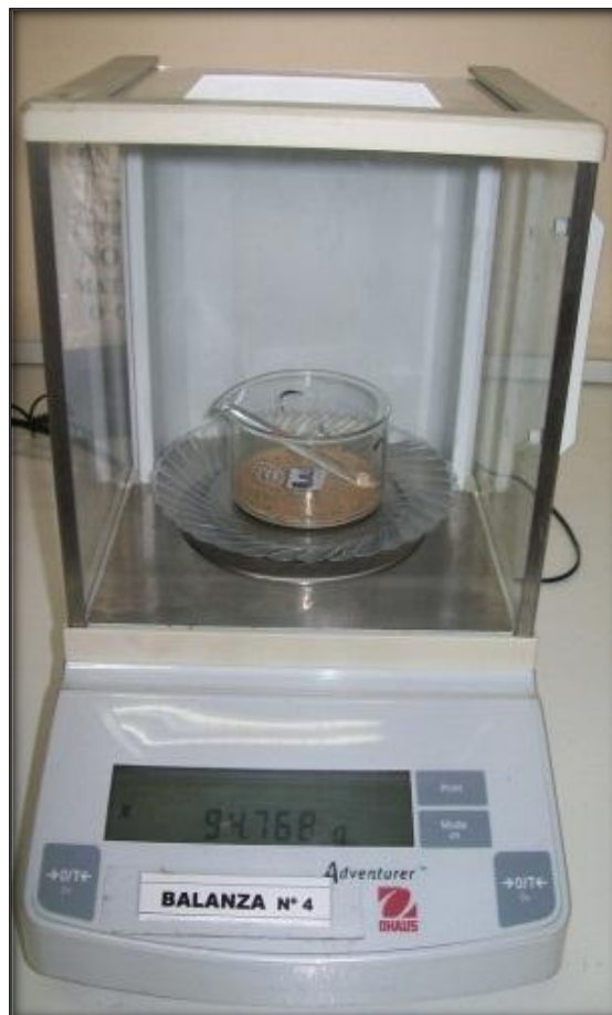
Imagen 18: Determinación del contenido de sólidos totales: Pesaje de capsulas.
