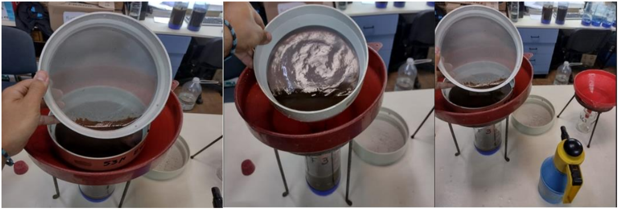
Figuras 7: Desarrollo del método tamizado húmedo de suelo para la obtención de las distintas fracciones. Fuente (Laboratorio Suelos UNLZ, 2023).
