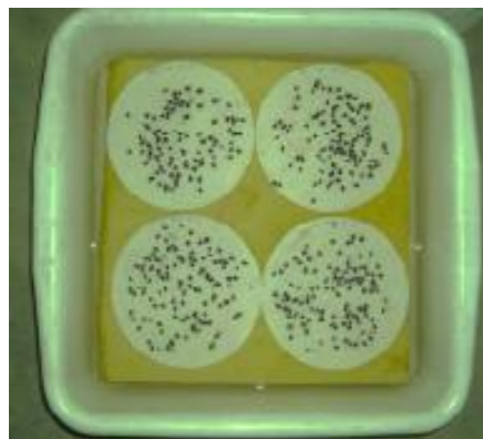
Figuras 10: Agregados sobre papel de filtro muestra el pretratamiento de humectación lenta. Fuente: ( Laboratorio Suelos UNLZ, 2023 ).
