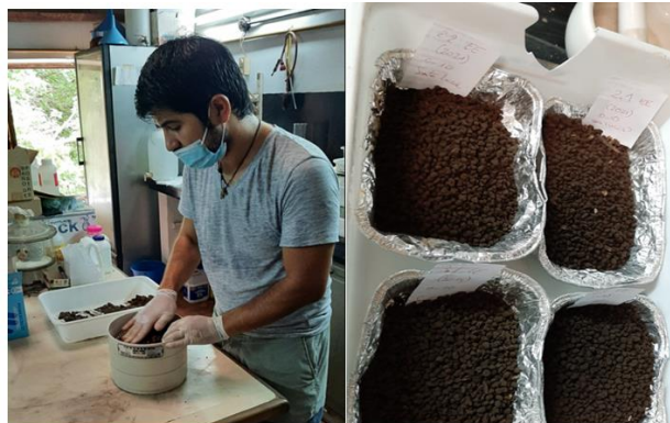
Figuras 8: Preparación de las muestras de suelo para determinar EA por metodología Le Bissonnais (1996). Fuente: (Laboratorio Suelos UNLZ, 2023).
