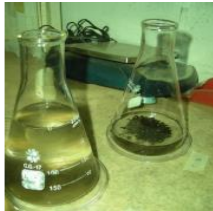
Figuras 11: Agitación en agua destilada de los agregados luego de estar inmersos en etanol es el otro pretratamiento. Fuente: (Laboratorio Suelos UNLZ, 2023).
