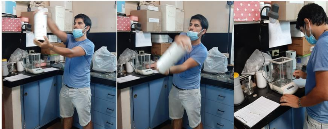
Figuras 13: Procedimiento de tamizado para cada pretratamiento. Fuente: (Laboratorio Suelos UNLZ, 2023).
