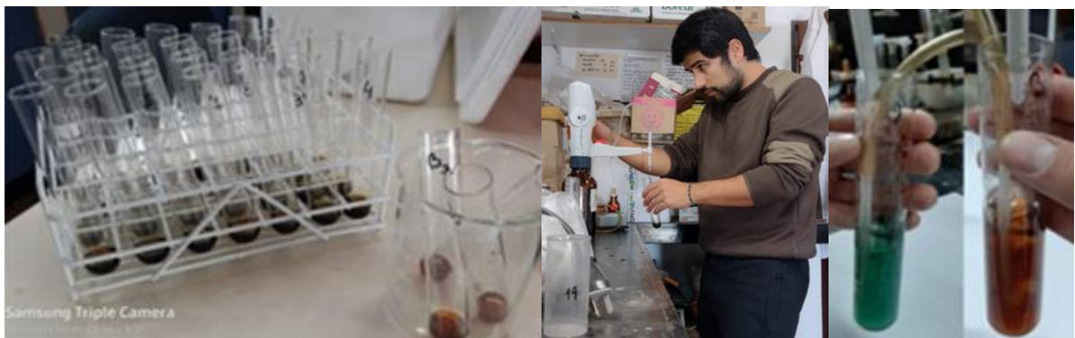
Figuras 6: Determinación de Carbono Orgánico en las muestras de suelo según Walkley & Black (Galantini, et al., 1994). Fuente: (Laboratorio Suelos UNLZ, 2023).
