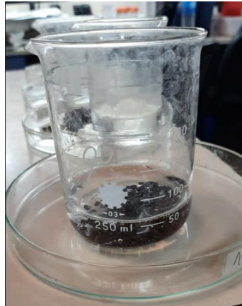
Figuras 9: Agregados vertidos en agua destilada marca el pretratamiento de humectación rápida. Fuente: ( Laboratorio Suelos UNLZ, 2023 ).
