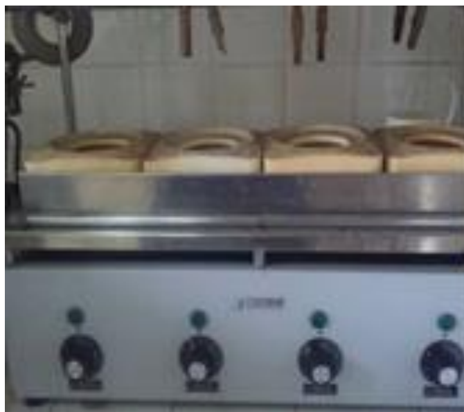
Figura 6: Equipo digestor (marca TecnoDalvo) Kjeldahl utilizado para realizar la digestión de las muestras para nitrógeno total.
