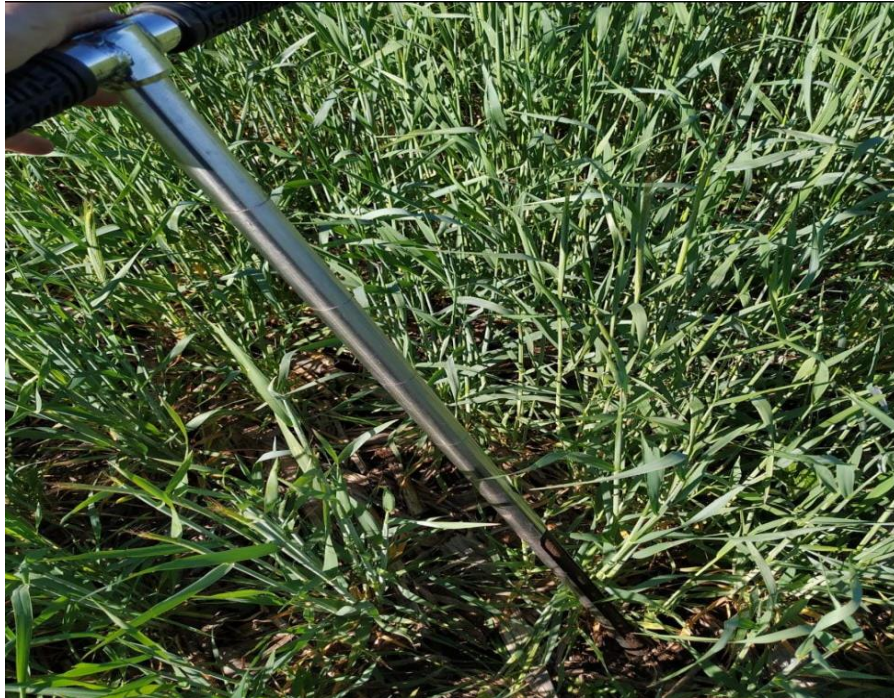
Figura 4: Muestreador tubular de suelo.
