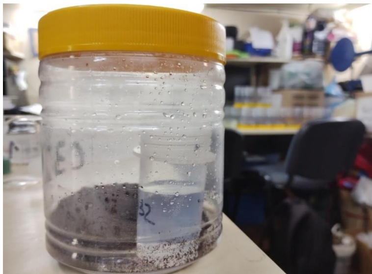
Figura 7 Frasco hermético de 750 cm 3 dentro la muestra de suelo y un recipiente conteniendo 20 ml de NaOH donde son llevados a cabo las mediciones de Biomasa total y de Respiración microbiana basal
