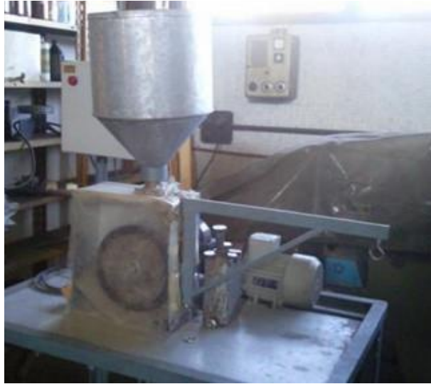
Figura 3.25. Máquina de ensayos abrasivo.
