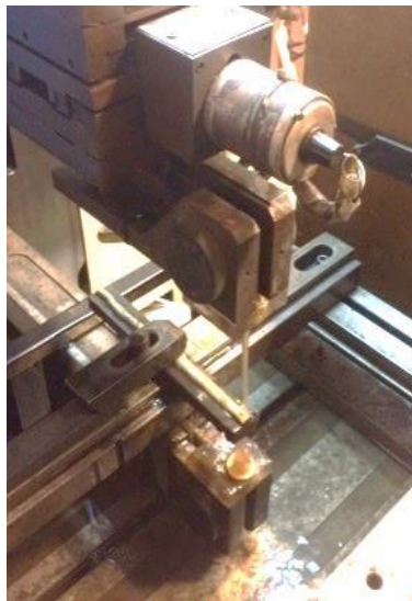
Figura 3.14 Maquinas cortadora para probetas
