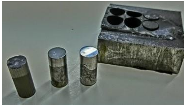
Figura 3.27 Extracción de muestras por corte por hilo.
