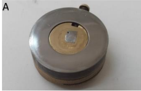
Figura 3.15 Tornillo porta probeta
