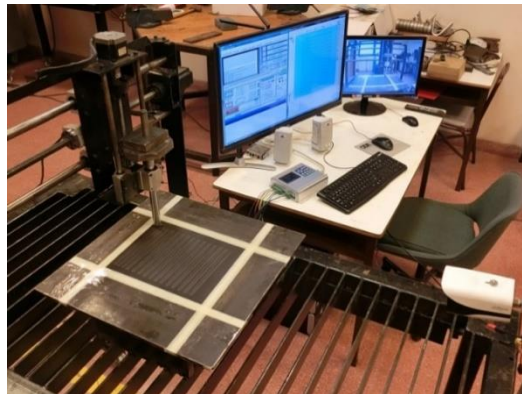
Figura 3.26. Tribómetro de desgaste de alta presión. Sistema Pin on Table
