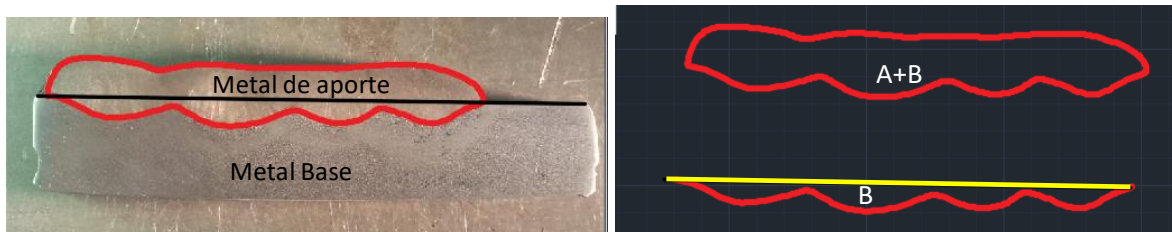
Figura 3.10. Calculo de dilución en cordones de multipasadas.
