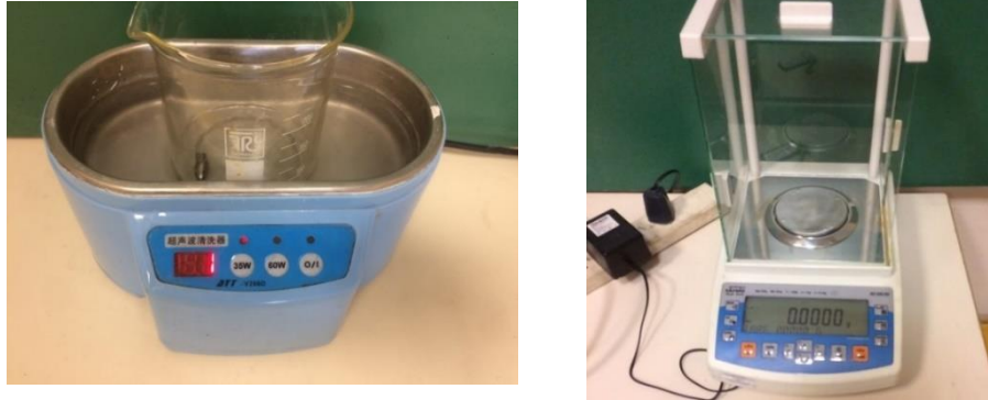
Figura 3.26 batea ultrasónica y balanza analítica
