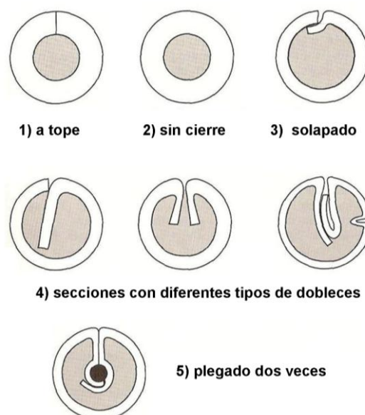
Figura 2. 14. Distintas configuraciones de alambres tubulares [16].
