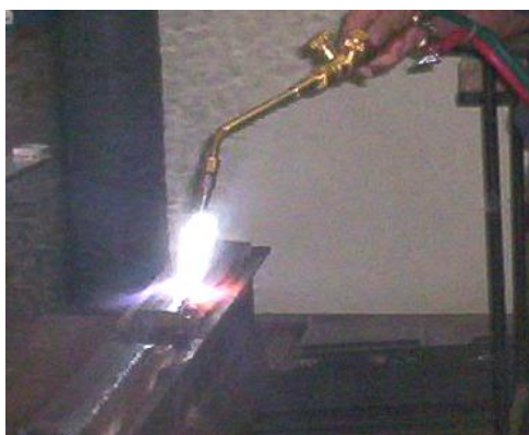
Figura 3. 6. Foto de precalentamiento del cupón.
