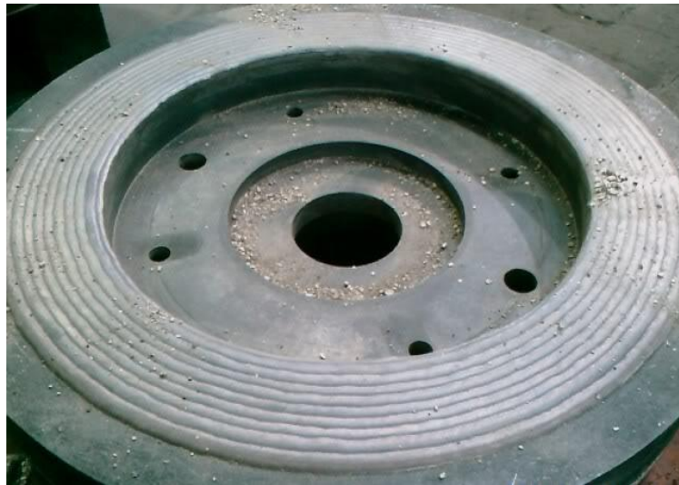
Figura 2. 2. Reparación de una matriz de forja [1].
