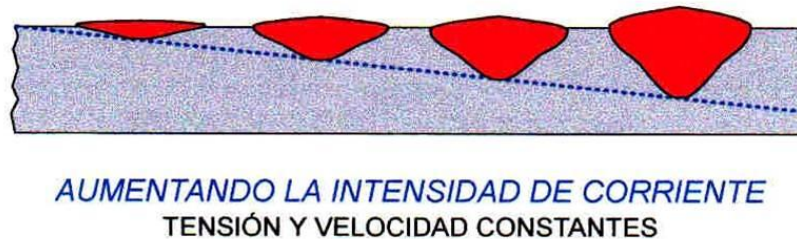
Figura 2. 17. Relación entre la forma del cordón y la corriente: baja, media y alta.
