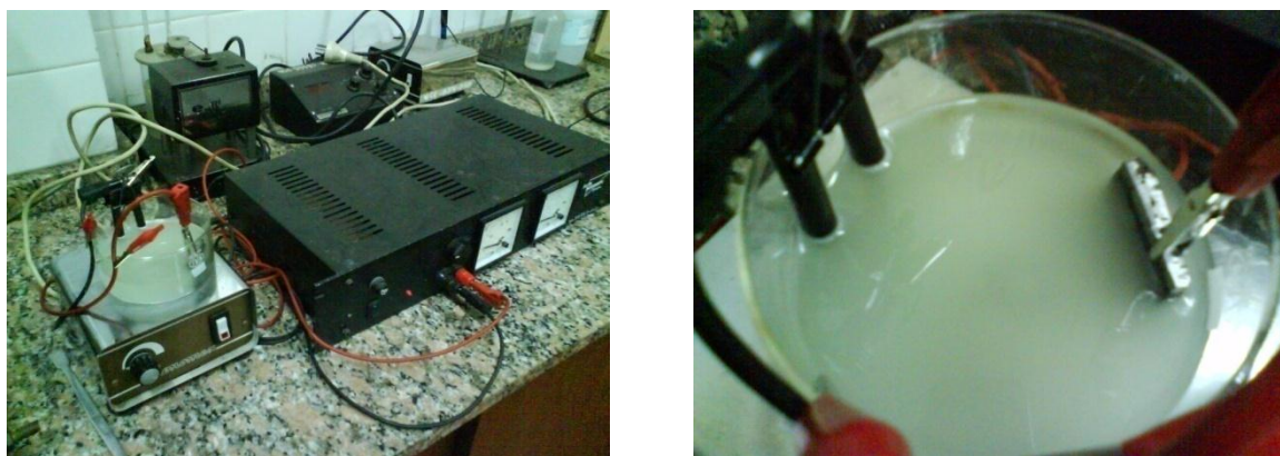
Figura 3. 13. Fuente de CC y disposición de los elementos para la electrólisis.
