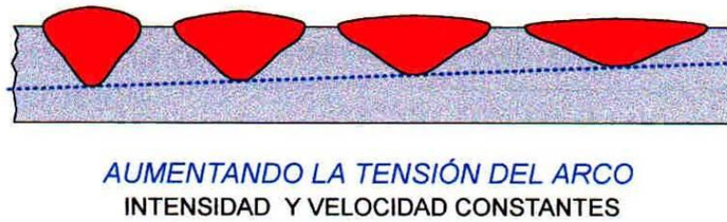
Figura 2. 16. Relación entre la forma del cordón y la tensión de arco.
