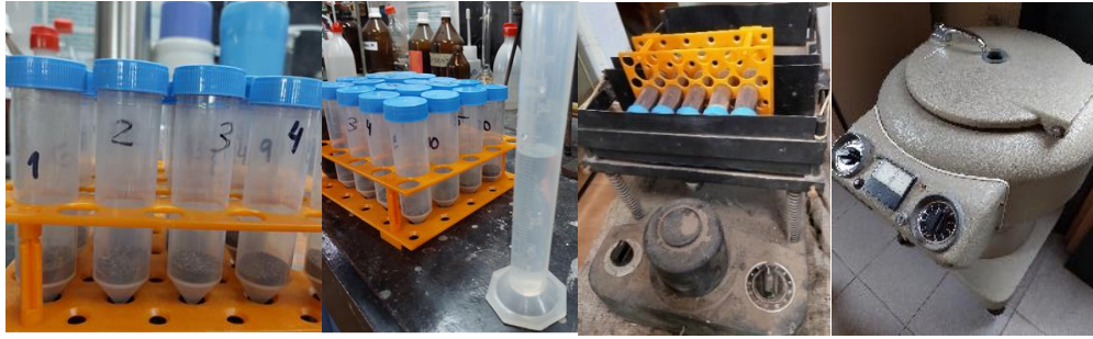
Figura 11. Secuencia de la preparación de las muestras para determinación de pH y CE.
