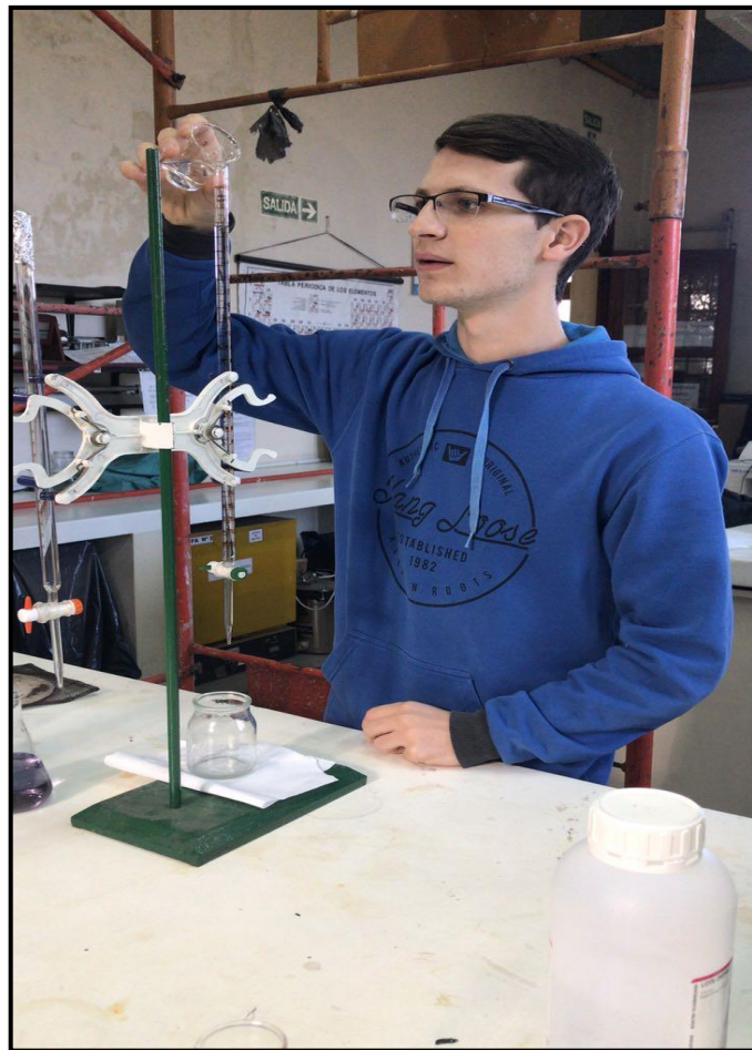
Figura 15: Etapa de titulación por Kjeldahl. Foto: G. Tubaro
