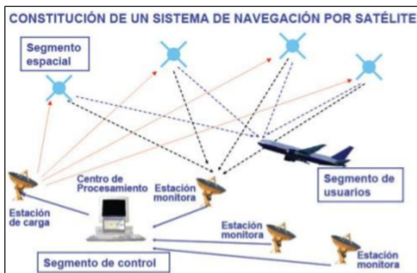
Figura 3. Representación del funcionamiento en conjunto de los tres segmentos del GNSS.
