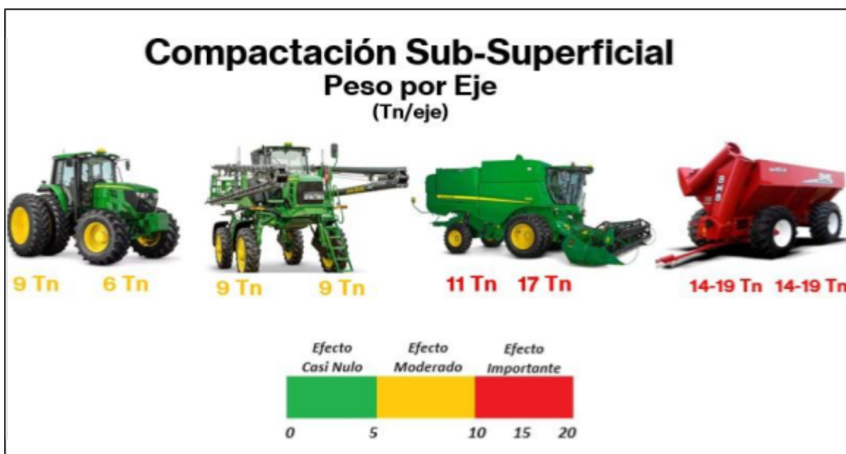
Figura 30. Diferentes maquinarias agrícolas y como afectan su peso en tn/eje, a la compactación subsuperficial, desde el más leve (verde) al más severo (rojo).
