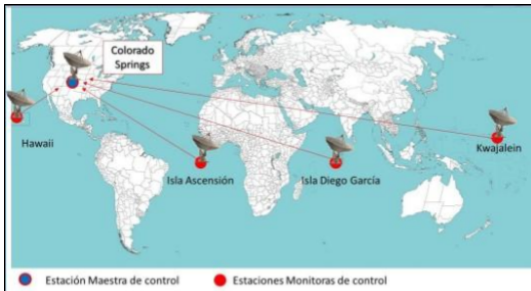
Figura 6. Representación del Segmento de Control GPS. Ubicación de la estación maestra y como las estaciones secundarias se comunican con ella.
