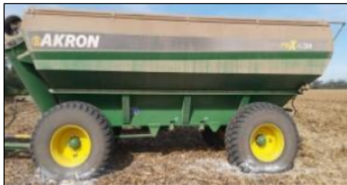
Figura 29 A. Medición de la superficie de pisado del neumático con el método de la cal.
