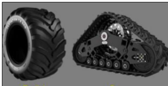
Figura 31 B. Neumático radial de alta flotación (izquierda), mayor superficie específica que los Diagonales y Radiales y ruedas orugas (derecha), el de mayor contacto suelo/neumático.
