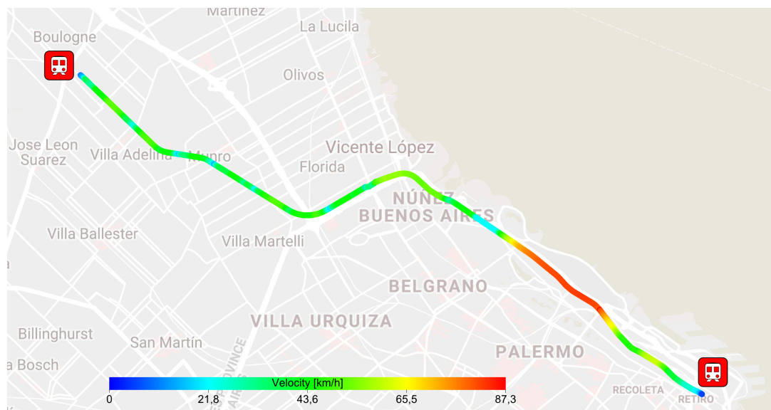
FIGURA 4.31: Velocidad de circulación por tramos
