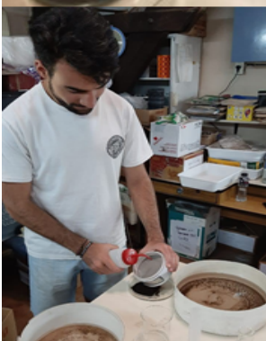
Figura 9: Lavado de la muestra con etanol
