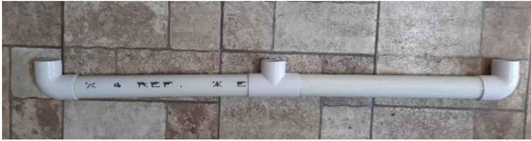
Figura 17: Vaso comunicante entre bateas inferiores
