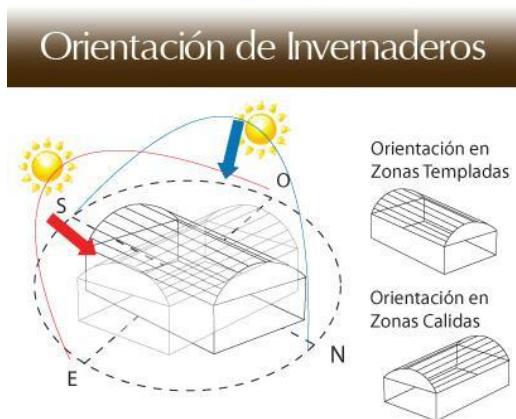
Figura 10 Orientación de invernaderos
