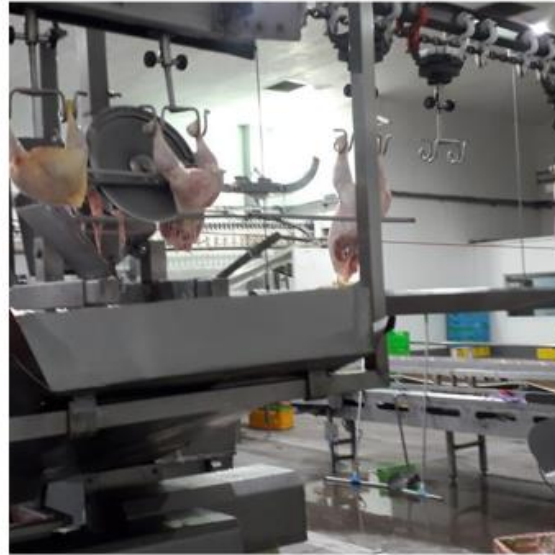
Hay sectores en el suelo donde se acumula agua y hay elementos de limpieza en el sector de producción.
