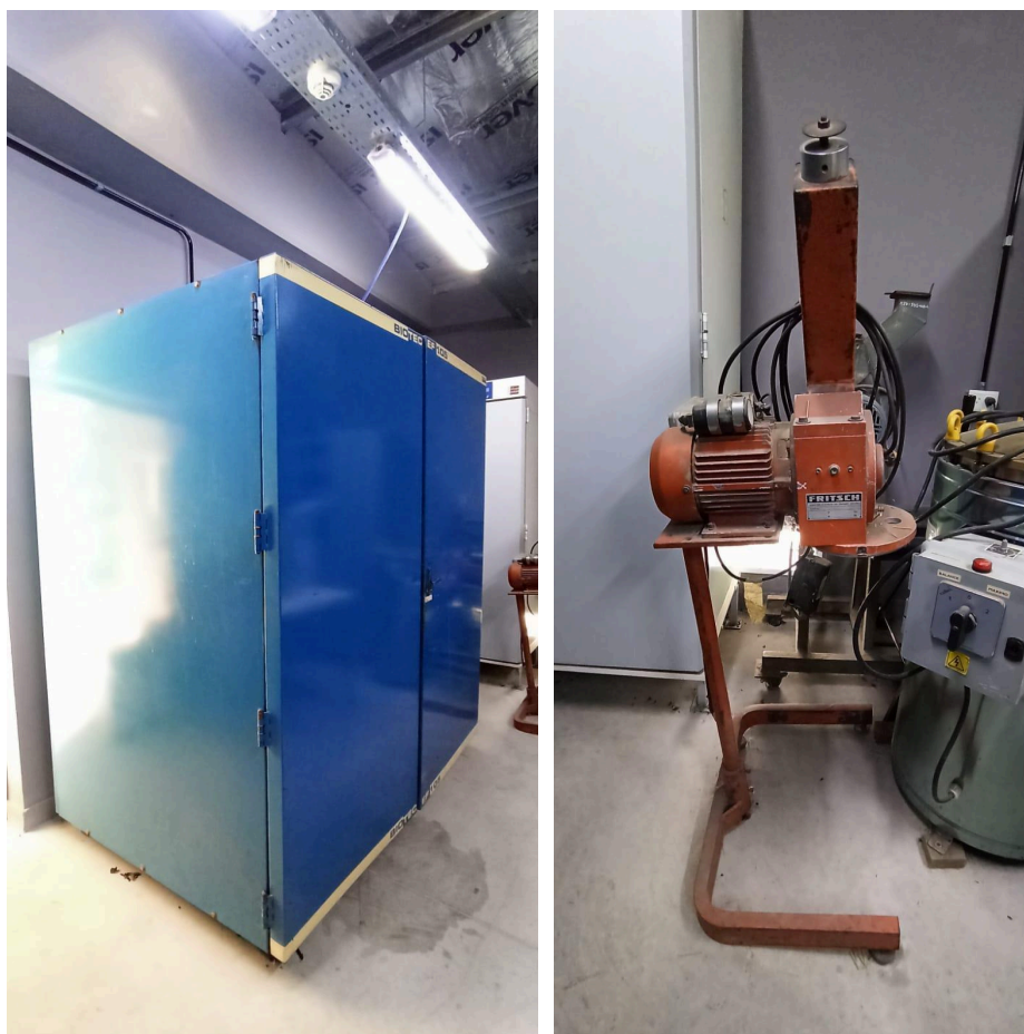
Figura 6. Fotografía de la estufa empleada para el secado de las muestras como así la picadora usada para moler las muestras.
