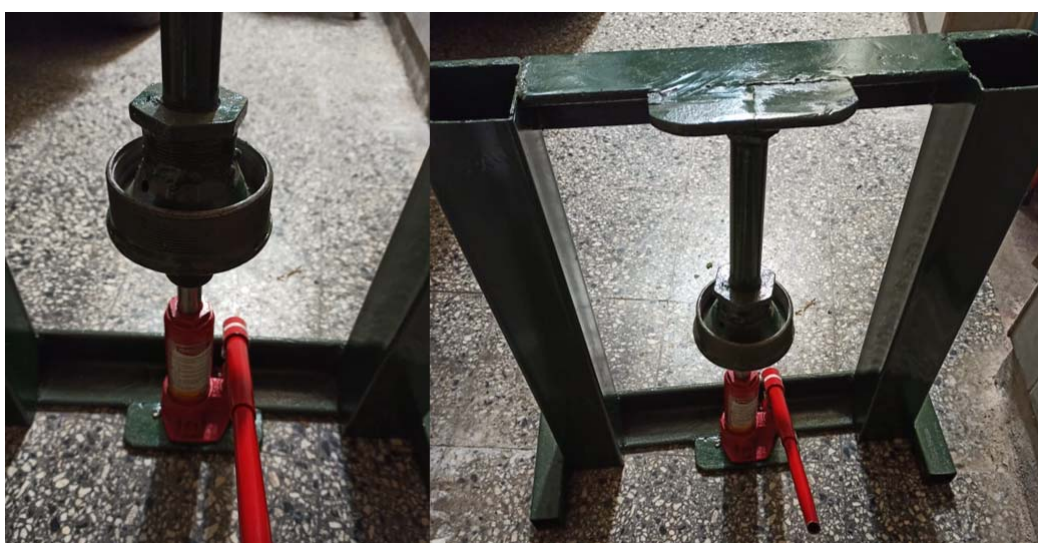
Figura 24. Prensa para la extracción del aceite de las semillas de ricino.
